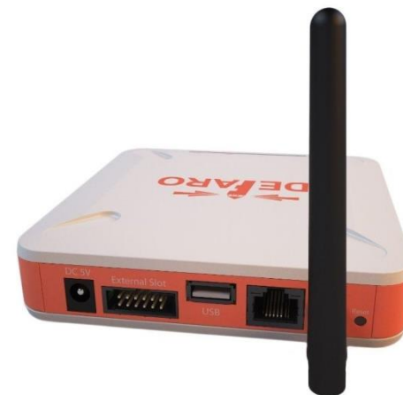
Рис.2 Внешний вид задней панели контроллера.
