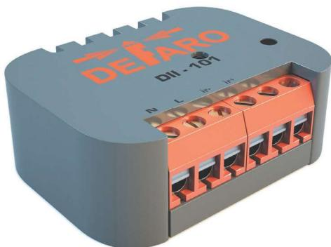
Модуль DII-101 предназначен для управления аудио/видео техникой из интерфейса контроллера. При настройке и обучении модуля с помощью специальной бесплатной программы CVD (Constructor Virtual Device) генерируется виртуальное устройство для контроллера. Воздействие на элементы управления этого виртуального устройства вызывает отправку заранее записанных в память модуля ИК-команд.
