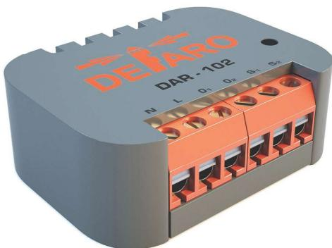
Модуль Z-Wave управления приводами DAR-102 коммутирует питание моторов 230В в приводах роллет, штор, жалюзи, маркиз, ворот гаража и т.д. Управляется модуль подключенными традиционными выключателями или Z-Wave радиокомандами. Модуль предназначен для установки за настенным выключателем в монтажной коробке.
