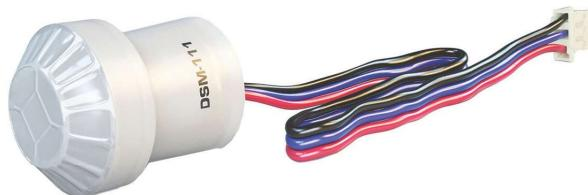
Датчик DSM-111 является пассивным инфракрасным детектором со встроенным сенсором освещенности. Датчик подключается к модулям DEFARO, оснащенным разъемом S-Bus. Подключение датчика расширяет возможности модулей, обеспечивает комфорт и безопасность пользователей.
