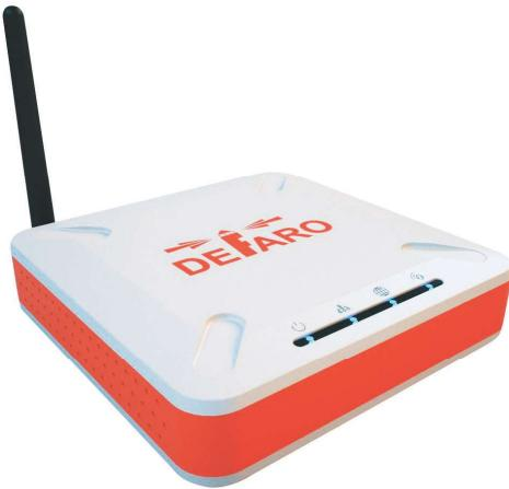
Шлюз-контроллер DEFARO DOMUS предназначен для управления сетью Z-Wave устройств, настройки параметров, создания сценариев автоматизации и дистанционного управления вашим умным домом.
