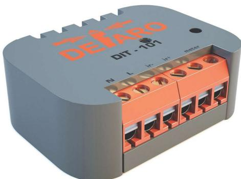
Z-Wave ИК термостат DIT-101 предназначен для управления кондиционерами с помощью ИК-команд. Термостат "обучается" ИК-командам от штатного пульта ДУ кондиционера с помощью бесплатной программы Configuration Tool, благодаря чему термостат может управлять любыми кондиционерами различных производителей.
