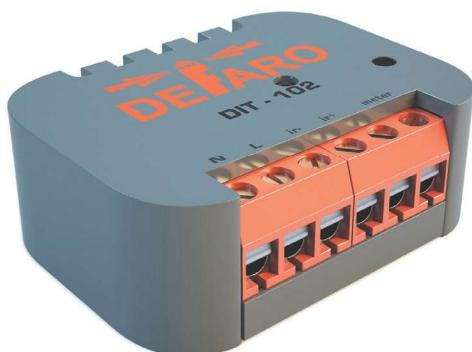
Z-Wave ИК термостат DIT-102 предназначен для управления кондиционерами с помощью ИК-команд. Термостат "обучается" ИК-командам от штатного пульта ДУ кондиционера с помощью бесплатной программы Configuration Tool, благодаря чему термостат может управлять любыми кондиционерами различных производителей. При работе с контроллером модуль представлен в виде термостата с переключением режимов и изменением заданной температуры.
