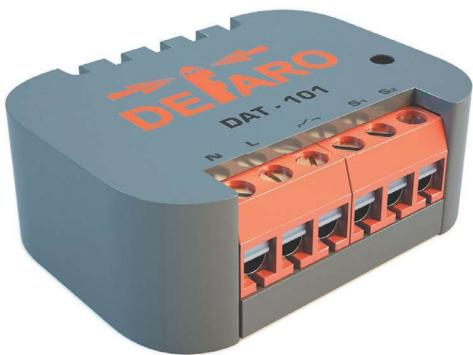
Z-Wave термостат DAT-101 предназначен для поддержания заданной температуры коммутацией подключенного к нему нагревательного элемента. Управляется модуль присоединенными традиционными выключателями или Z-Wave радиокомандами. Модуль предназначен для установки за настенным выключателем в монтажной коробке. Модуль DAT-101 может коммутировать нагрузку с напряжением питания, отличным от напряжения питания самого модуля.
