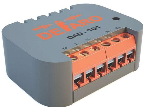
Модуль DAD-101 - Z-Wave диммер, предназначенный для регулирования яркости источников света. Управляется модуль подключенными к нему традиционными выключателями или Z-Wave радиокомандами. Модуль предназначен для установки за настенным выключателем в монтажной коробке.
