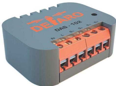
Модуль двухканального Z-Wave реле DAS-102 коммутирует две независимые нагрузки мощностью до 1,8 кВт каждая. Управляется модуль подключенными традиционными выключателями или Z-Wave радиокомандами. Модуль предназначен для установки за настенным выключателем в монтажной коробке.
